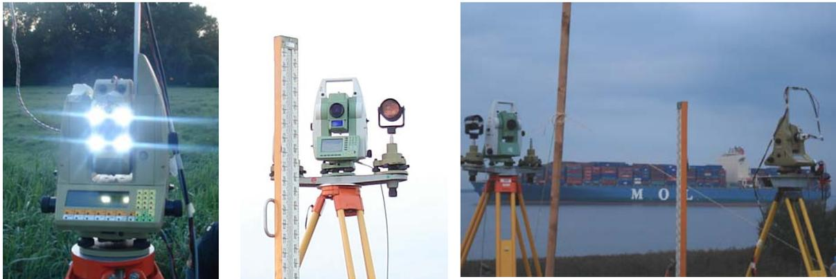
**Abb. 2:** Links: Daedalus (ETH Zürich) mit eingeschaltetem Diodenarray als Zieleinrichtung, Mitte: TCRP 1201 (HCU Hamburg) mit exzentrischem Reflektor und Nivellierlatte für die Bestimmung der Instrumentenhöhe, rechts: Beide Messsysteme im Einsatz auf dem Norddeich bei Scheelenkuhlen.
